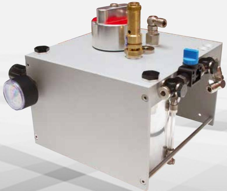
Die Minimalmengenschmierung (MMS) oder auch Minimalmengen-Kühlschmierung (MMKS) genannt arbeitet nach dem Prinzip „weniger ist mehr“. Dabei kommt ein Kühlschmiermittel-Luft-Gemisch zum Einsatz, das durch optimale Schmierung die Entstehung von Reibungswärme verhindert. Die restliche Wärme wird über das Werkzeug und den Span abgeführt.
