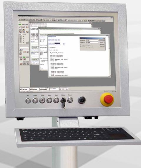
Die **CNC-Bedieneinheiten iOP-19** sind eine überarbeitete Version des bisherigen isil Bedienpanels iBP. Alle Erfahrungen wurden in die Neuentwicklung der iOP-19 eingebracht. Sie verfügen über einen integrierten 19"-Touchscreen-Monitor, eine Silikontastatur sowie ein Bedienfeld mit Edelstahltasten und Not-Aus-Schalter. Über die herausgeführten Standard-Anschlussleitungen kann beim iOP-19-TFT ein PC angeschlossen und bedient werden. Das iOP-19-CPU verfügt über einen isil CAN.
